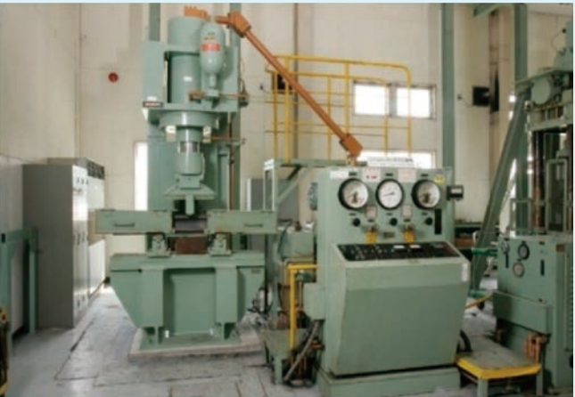
レール実物曲げ疲労試験機
