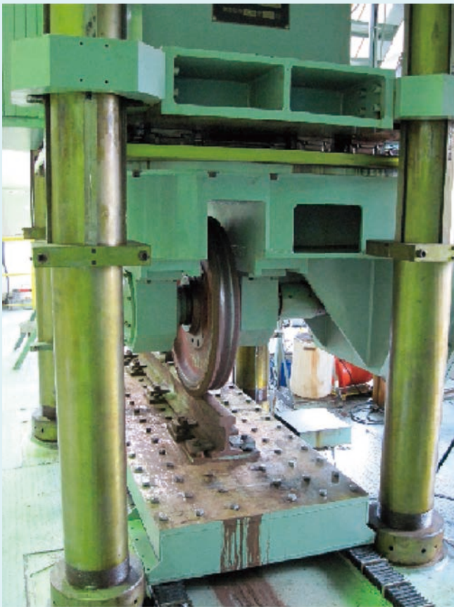
レール損傷シミュレータ
