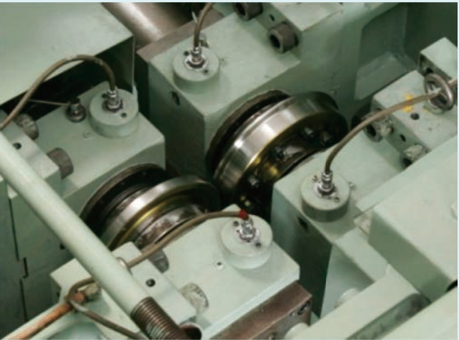
レール摩耗・損傷再現試験機
